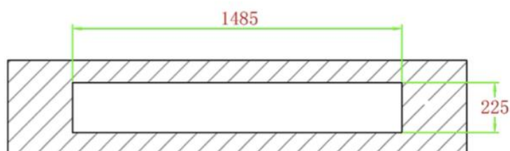
壁炉平面开孔尺寸
