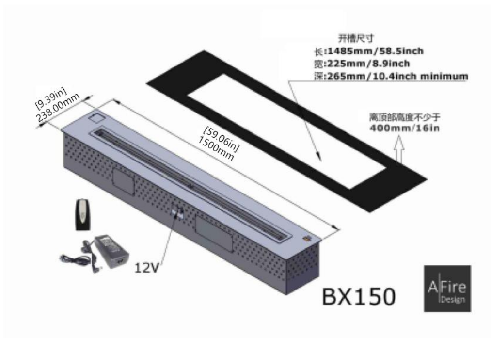
安装槽尺寸数据 Mounting slot size data
